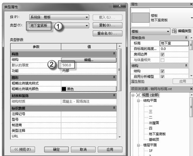
图 3.1.81 设置地下室底板
